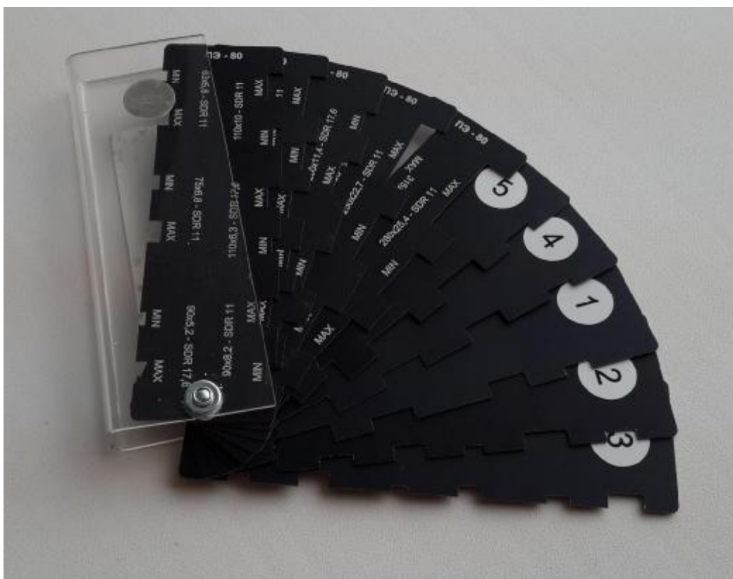
Рисунок 2 – Общий вид шаблонов полиэтиленовых стыков ШПС-1
