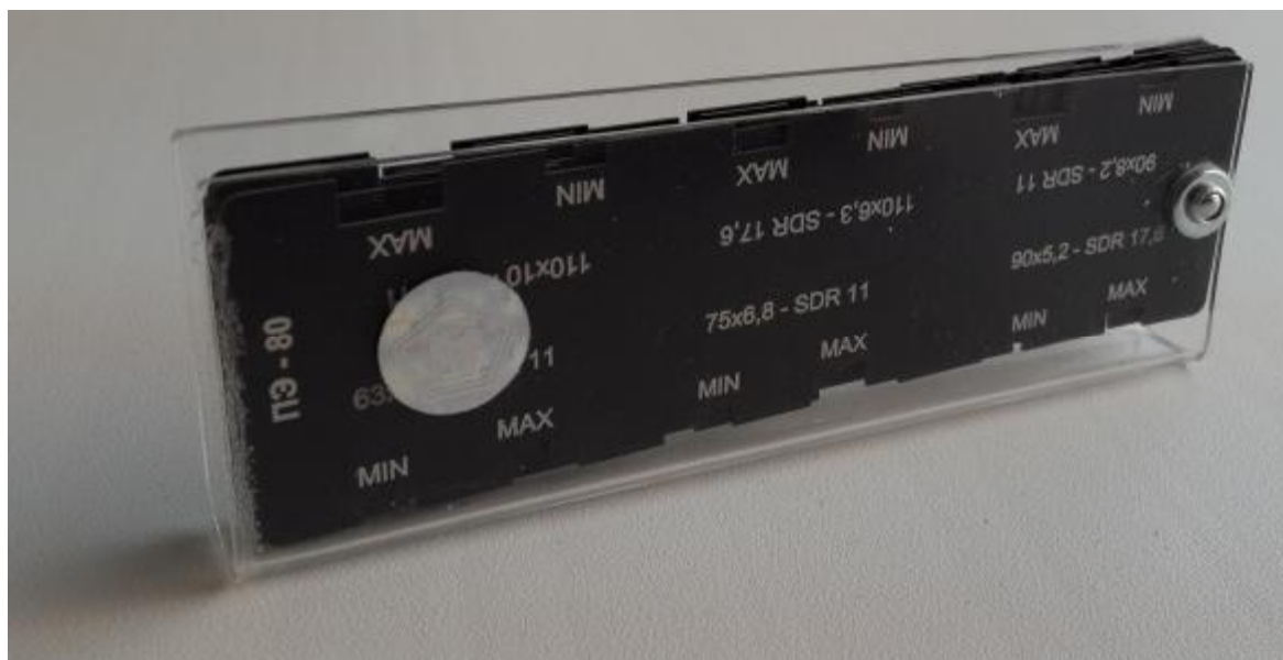
Рисунок 1 – Общий вид шаблонов полиэтиленовых стыков ШПС-1
