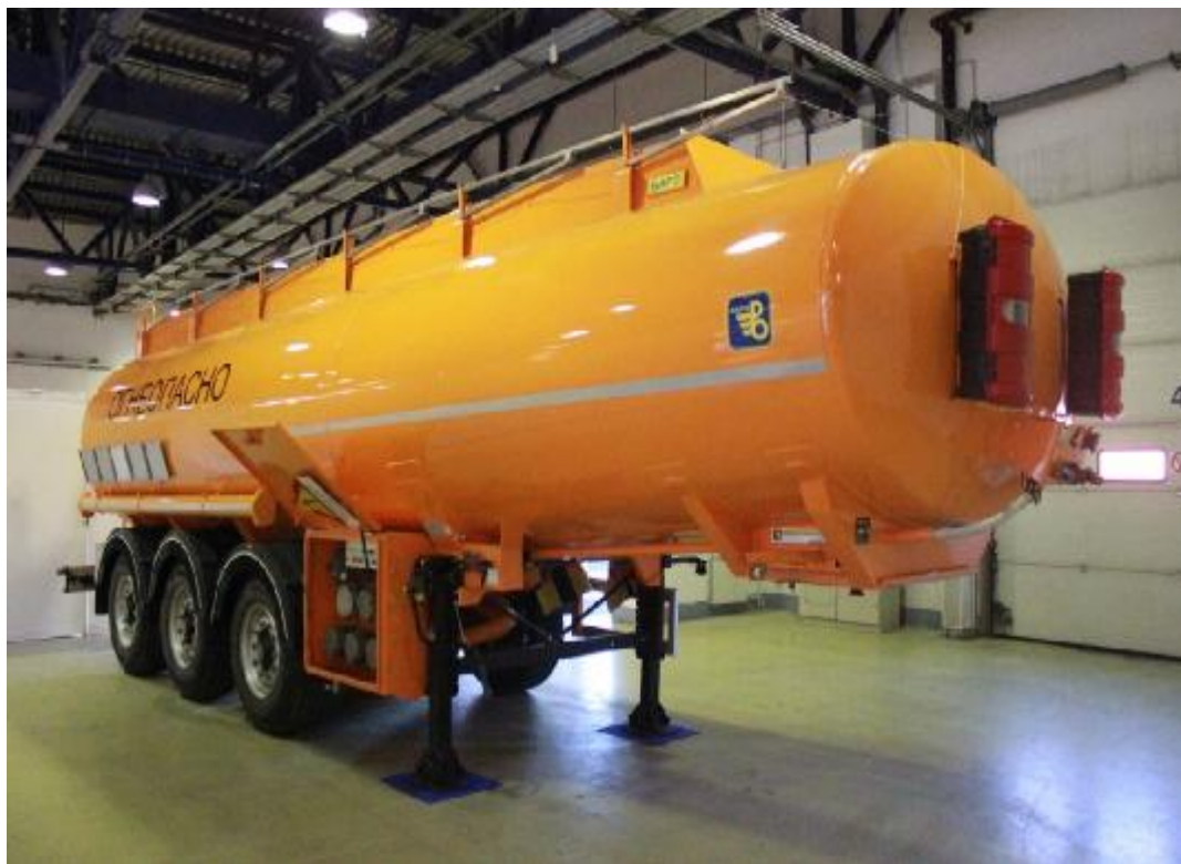
Рисунок 1 - Общий вид полуприцеп-цистерны НПЦ
