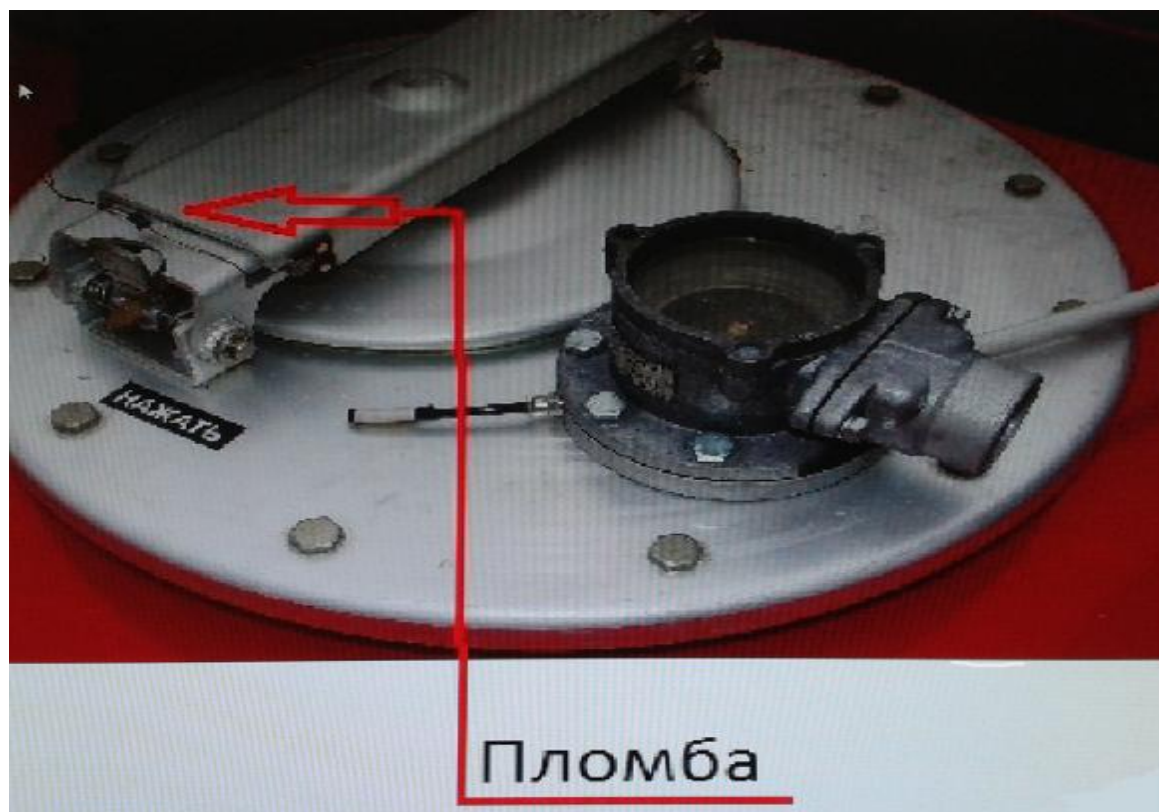
Рисунок 2 – Место пломбирования крышки
