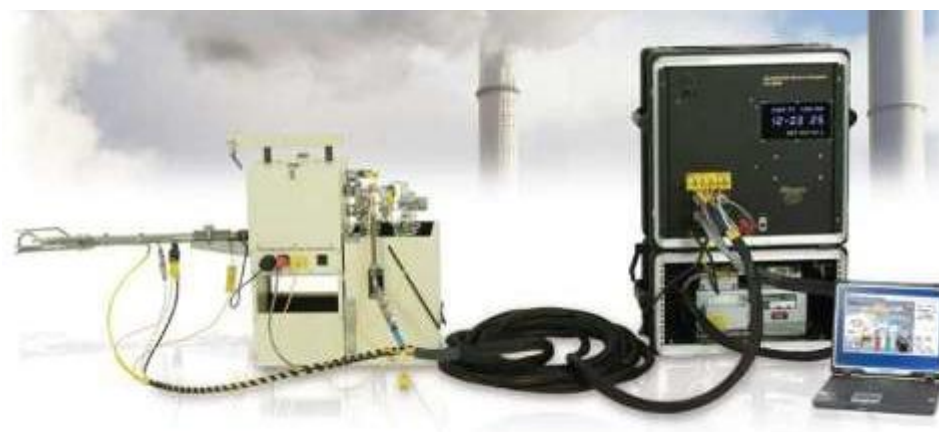
Рис.1. Внешний вид системы изокинетического отбора проб промышленных выбросов XC-5000
