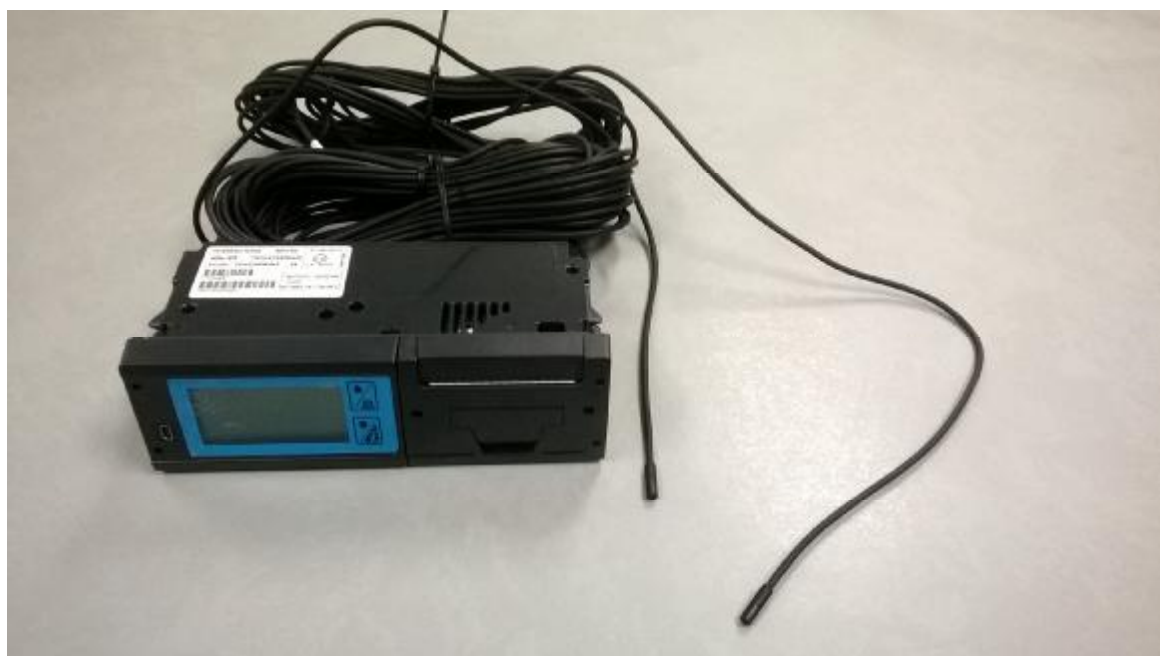
Рис.3 Регистратор с 2-мя подключенными датчиками температуры кабельного типа
