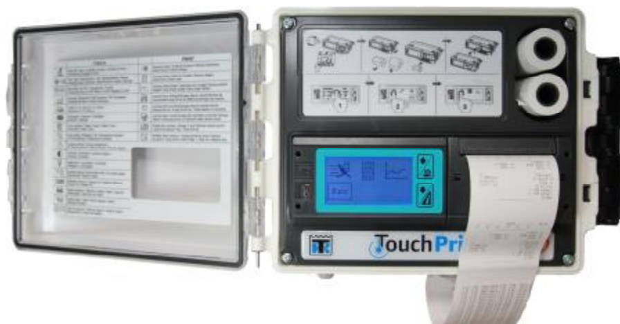
Рис.2 Регистратор в защитном корпусе (для наружного монтажа)
