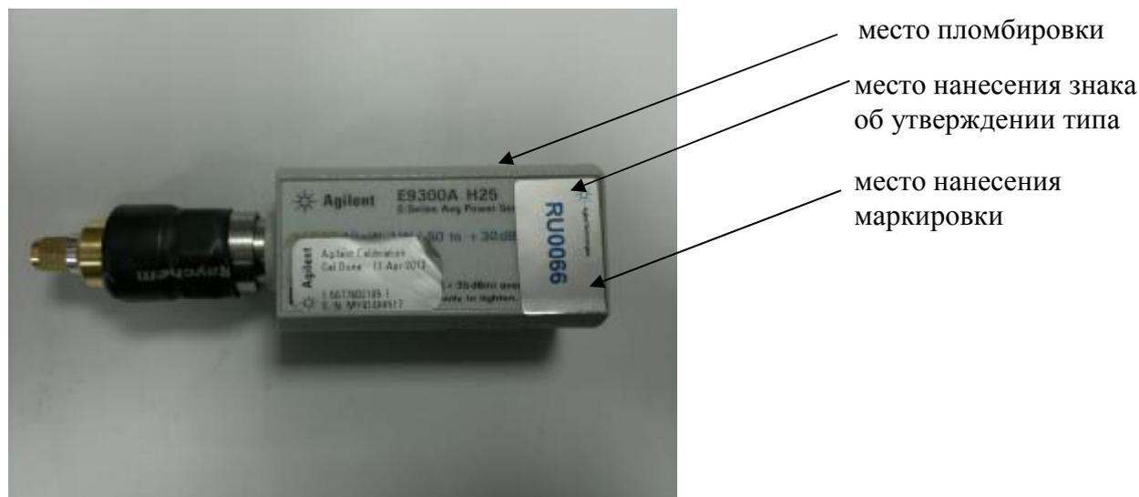
Рисунок 3 – Вид преобразователей измерительных E9300A с опциями H24, H25
