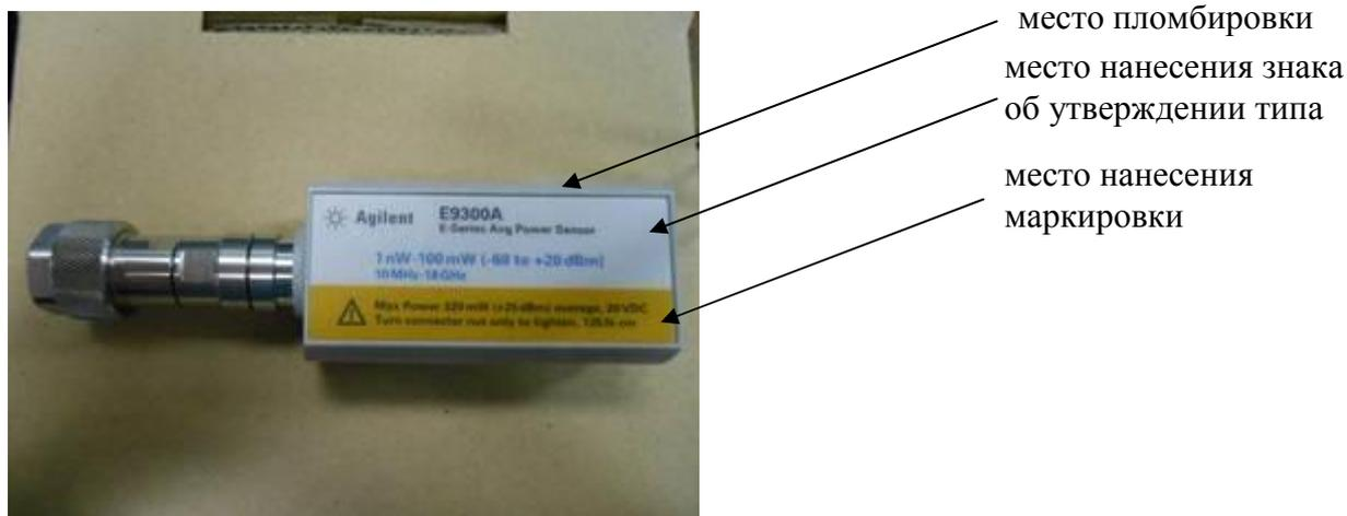
Рисунок 1 – Вид преобразователей измерительных E9300A, E93301A, E91304A
