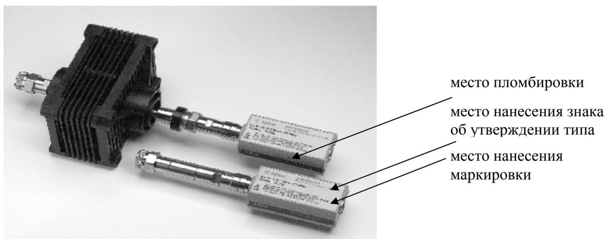
Рисунок 2 – Вид преобразователей измерительных E9300H, E9301H, E9300B, E9301B
