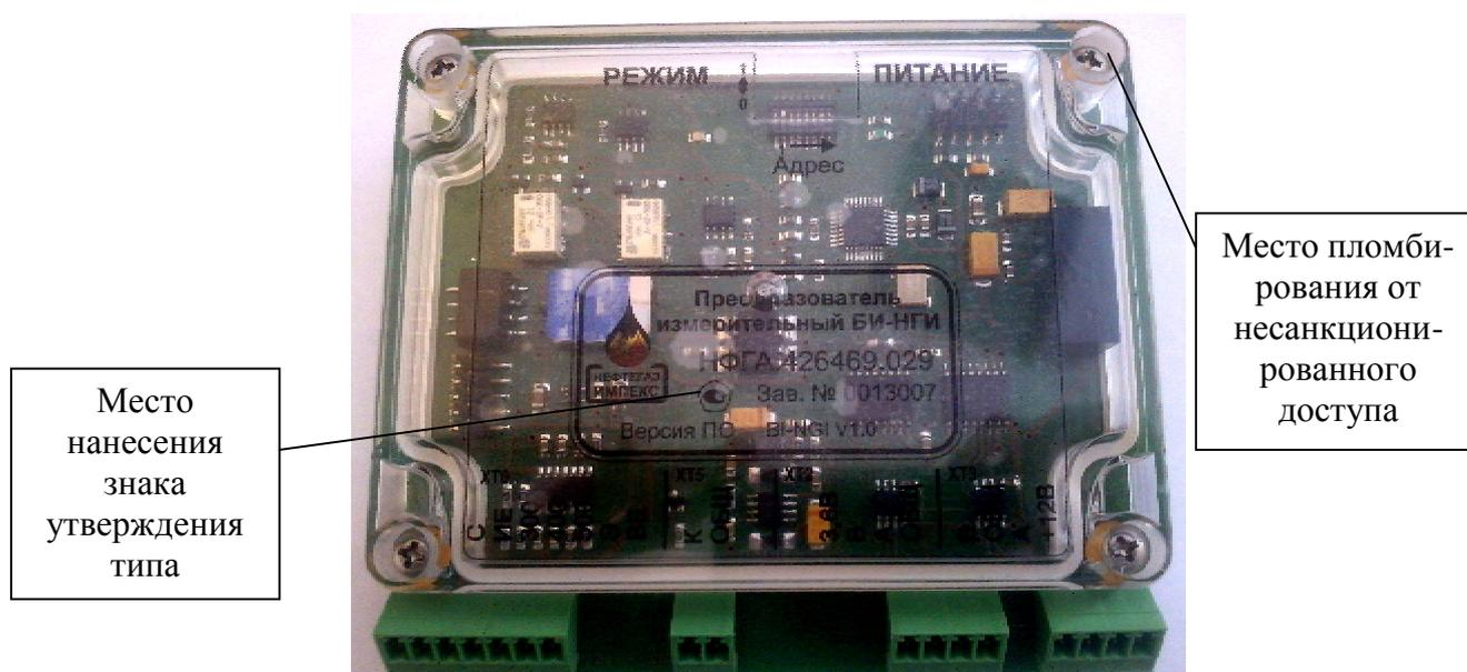
Рисунок 1 - Внешний вид преобразователя и схема пломбировки от несанкционированного доступа
