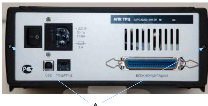
Рисунок 3. Вид измерительного блока АПК-ТРЦ сзади
