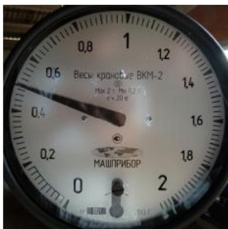
Рисунок 2 – Маркировка весов
