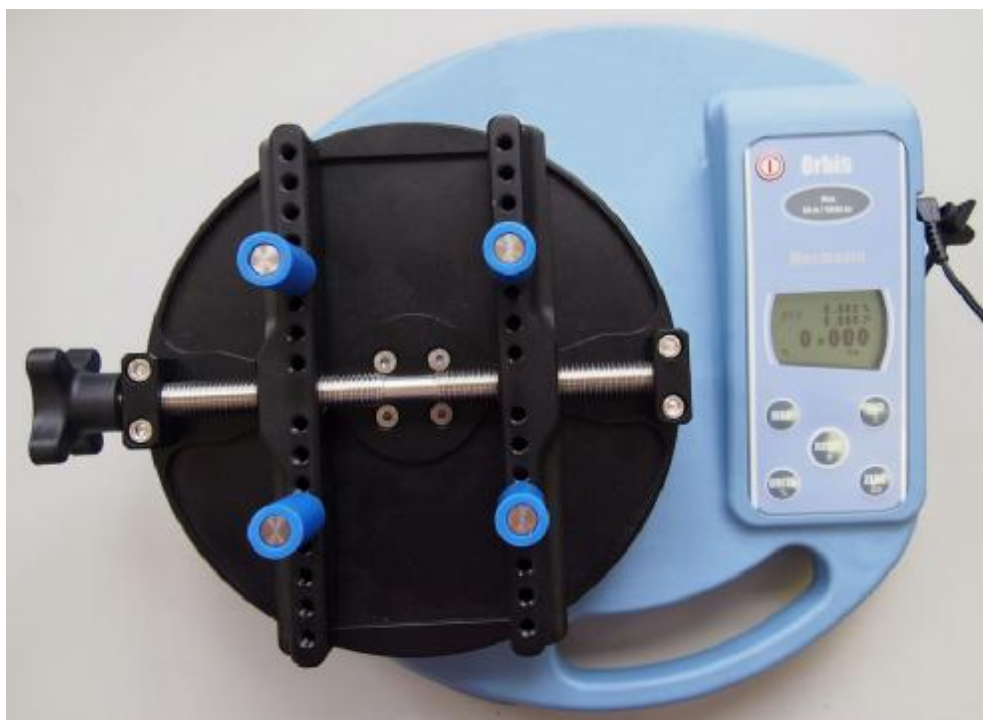
Рис. 1. Фотография общего вида измерителя крутящего момента силы Orbis.
