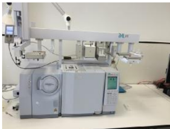
Рис. 1. Фотография общего вида хромато-масс-спектрометра модернизированной модель GCMS-QP2010Ultra.
