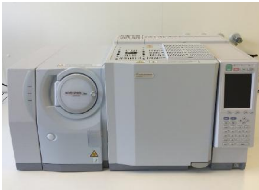
Рис. 2. Фотография общего вида хромато-масс-спектрометра модернизированной модель GCMS-QP2010SE.
