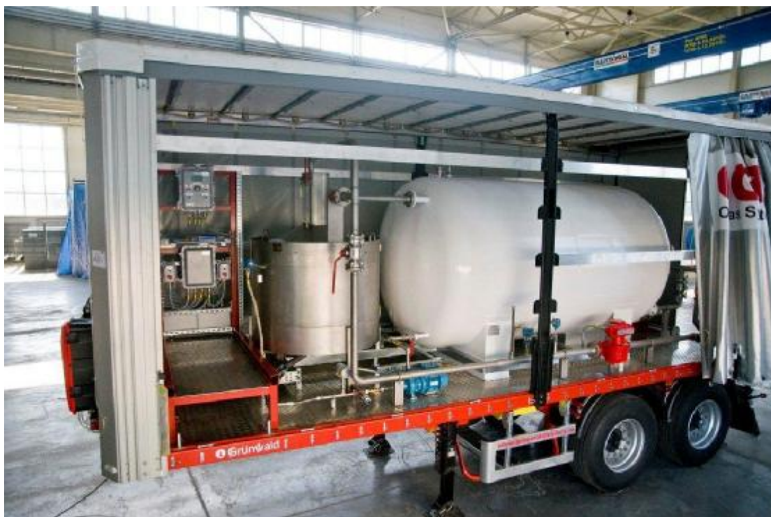
Рисунок 1 – ЭУ OGSB передвижного исполнения
