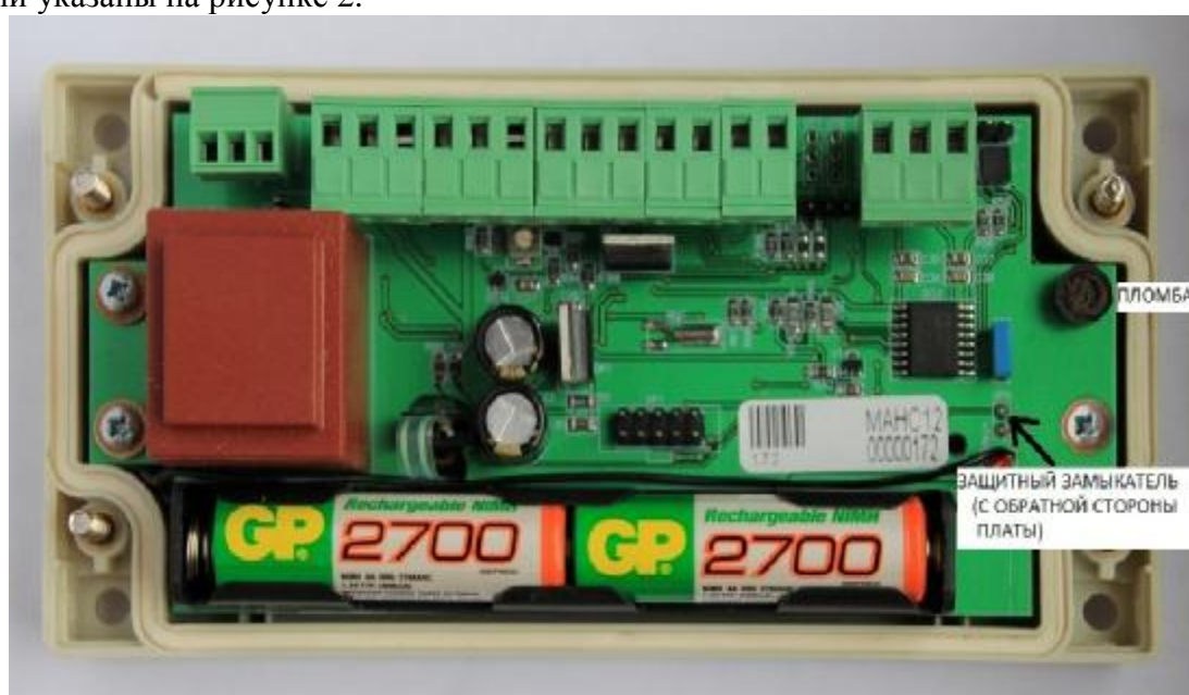
Рисунок 2 – Места маркировки и пломбировки
