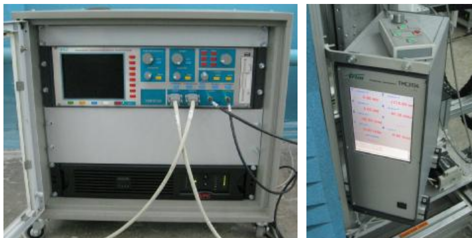
Рисунок 1 – Внешний вид аппаратной стойки комплекса со стробоскопическим осциллографом TMR 8140 (слева), контроллер ОПУ и сканера (справа)
