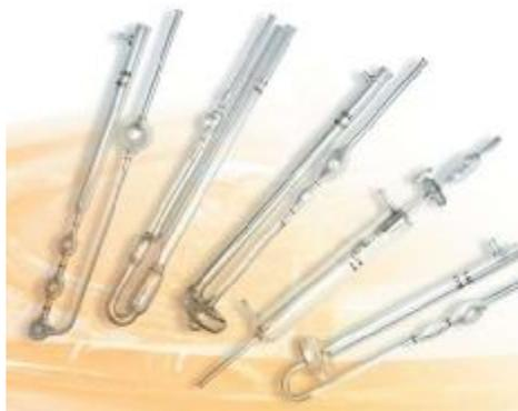
рис. 1 Вид вискозиметров (слева направо ВНЖ, ВПЖ-1, ВПЖ-2, ВПЖ-3, ВПЖ-4)
