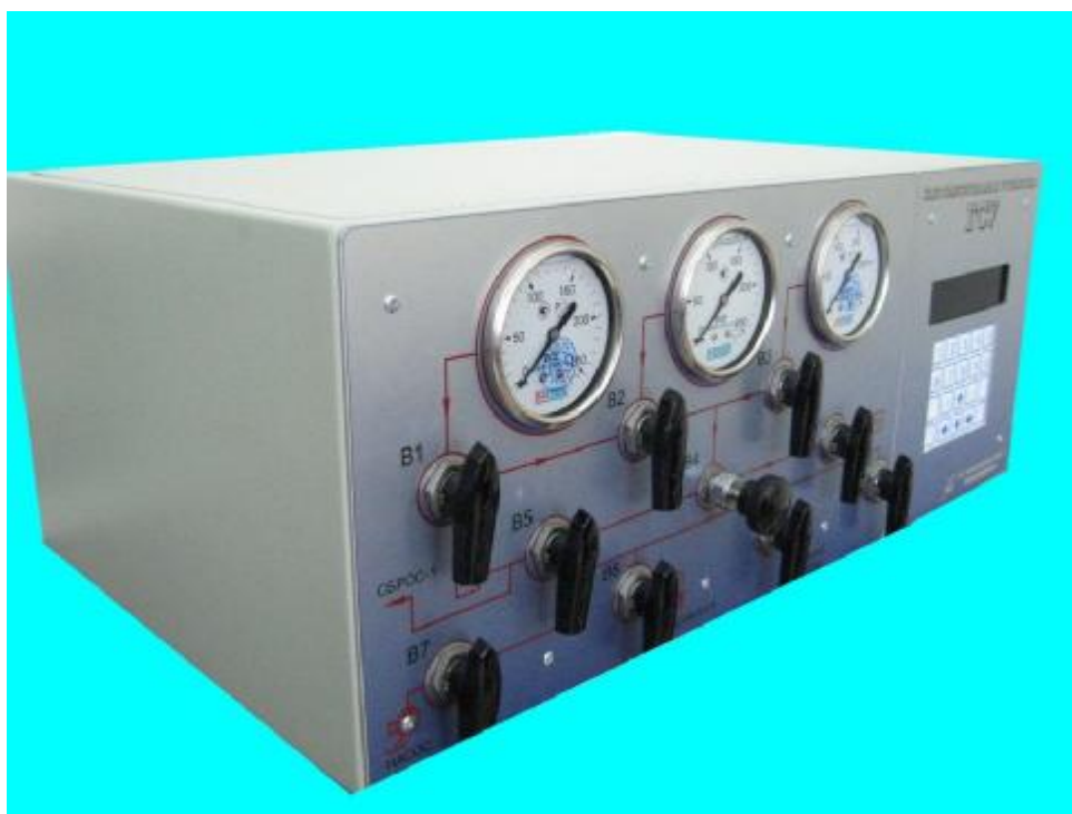
Рисунок 1. Общий вид газосмесительной установки ГСУ.
