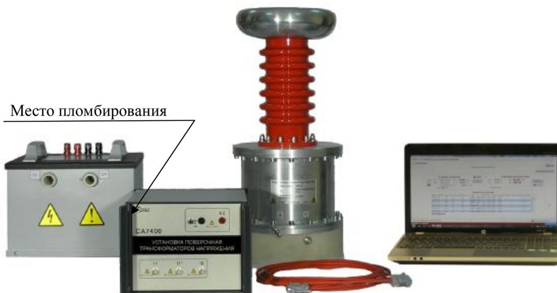
Рис. 1 – Внешний вид установки поверочной трансформаторов напряжения СА7400
