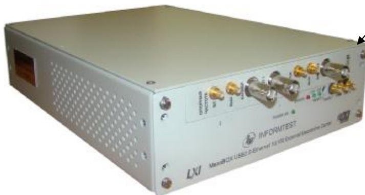
Рисунок 2 – Внешний вид устройства MezaBox с установленным осциллографом
