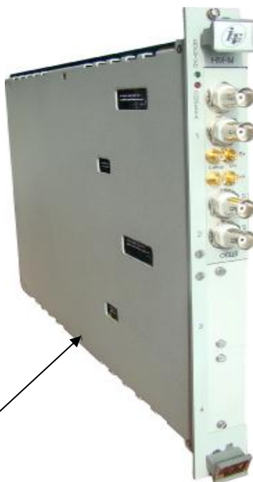
Рисунок 4 – Внешний вид носителя мезонинных модулей НМ-М с установленным осциллографом
