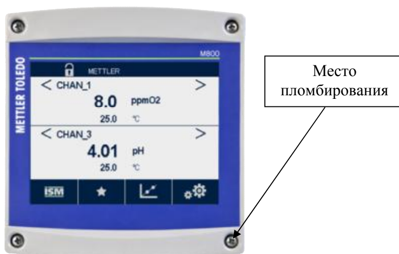
Рис. 1. Внешний вид микропроцессорных блоков измерителей M800 с каналом мутности. Вид спереди.
