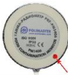
Рисунок 2. Место пломбирования гамма – радиометра РКГ-РМ1406 от несанкционированного доступа (находится на основании прибора)
