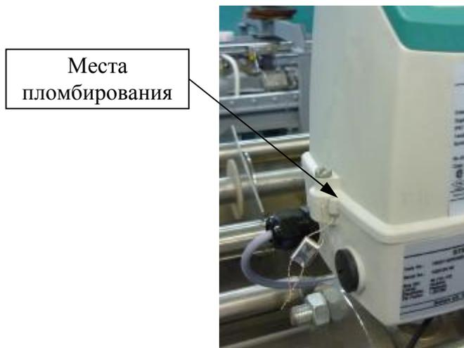
Рисунок 2 – Места пломбирования
