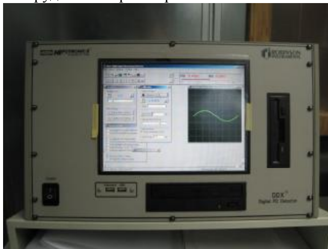
Рисунок 1. Внешний вид передней измеритель частичных разрядов DDX-8003
