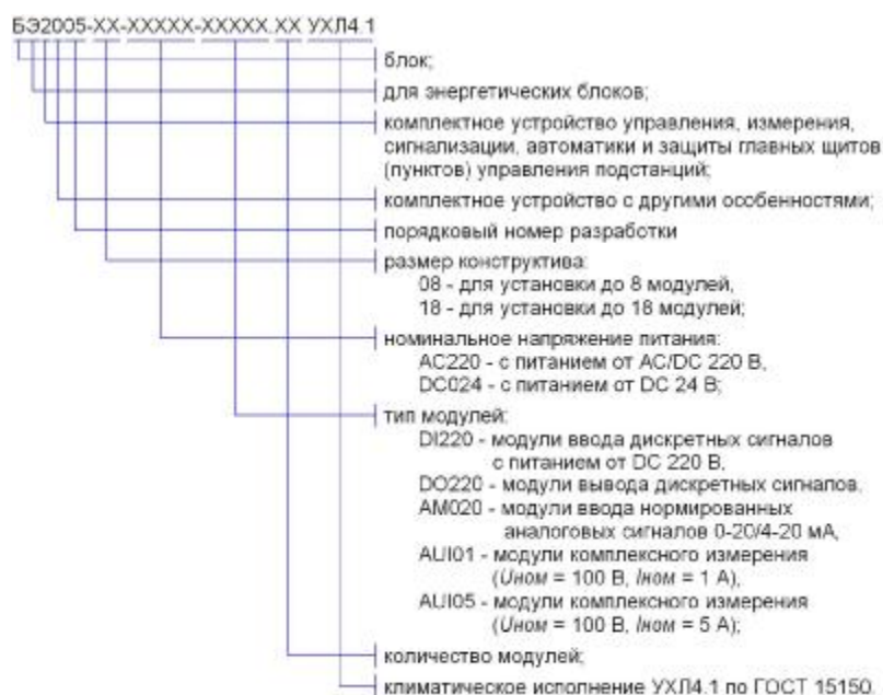
Рисунок 2 – Структура условного обозначения исполнения контроллера (код заказа)
