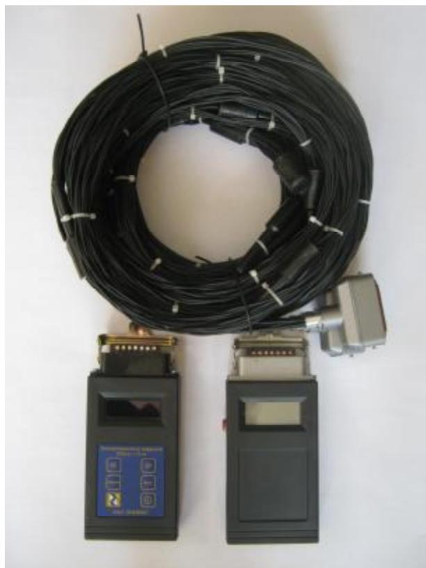
Рис.1. Комплект для полевого измерения температуры грунтов.
