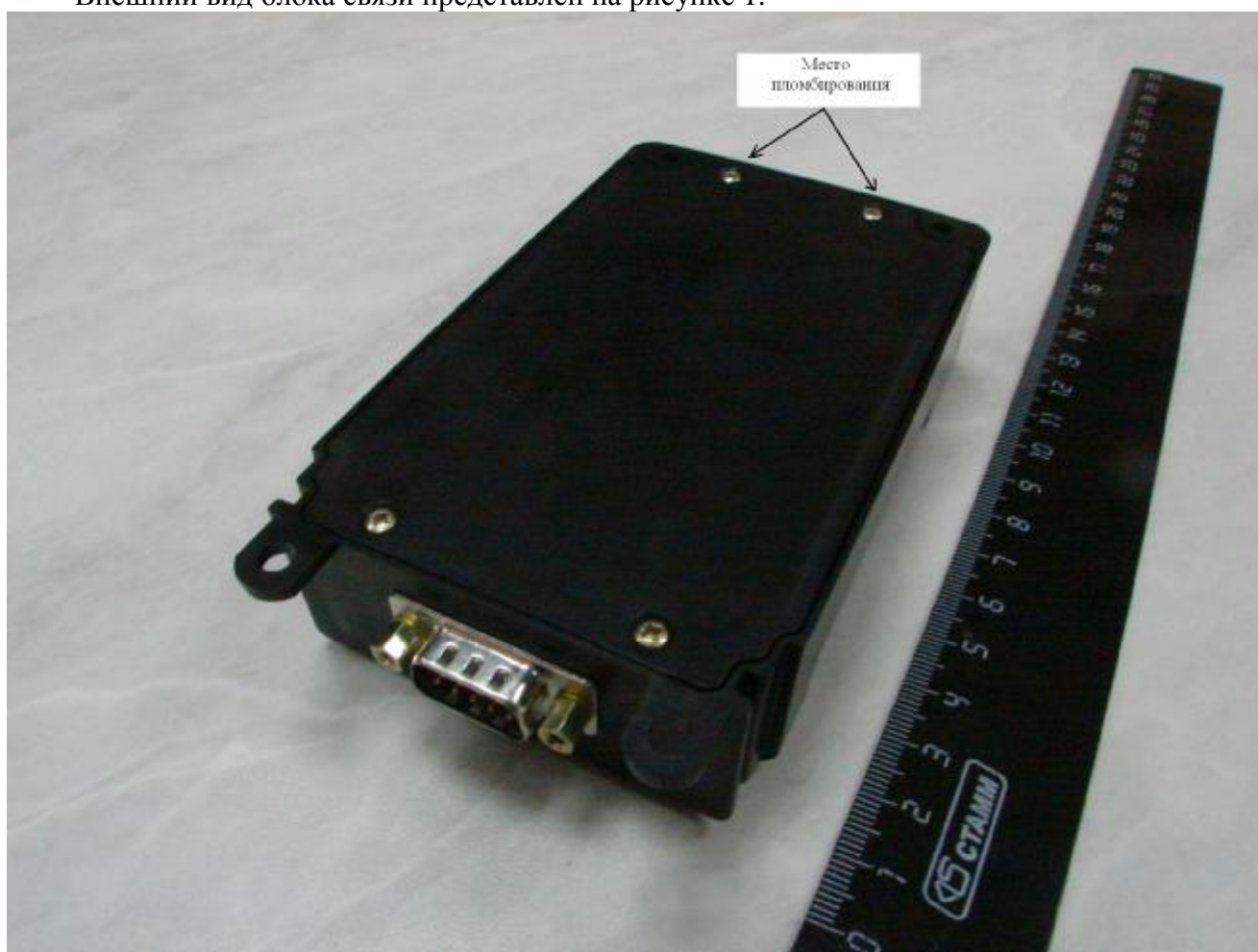
Рисунок 1. Внешний вид блока связи со съемным носителем информации БС-СН/САУТ.
