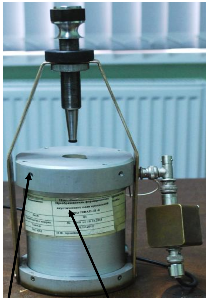
Рисунок 3 - Общий вид калибратора-преобразователя акустического поля продольной волны (УКП-АПП)
