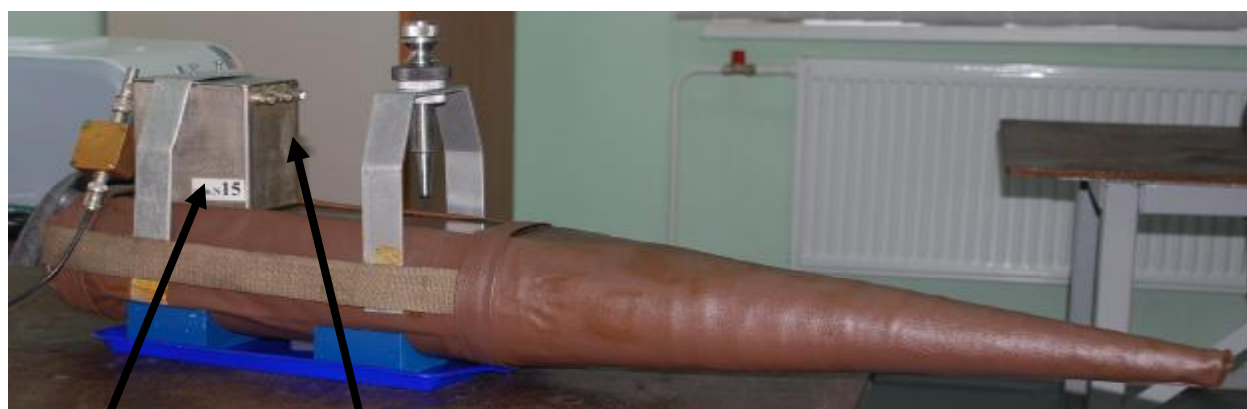
Рисунок 2 - Общий вид калибратора-преобразователя акустического поля волны Рэлея (УКП-АПР)
