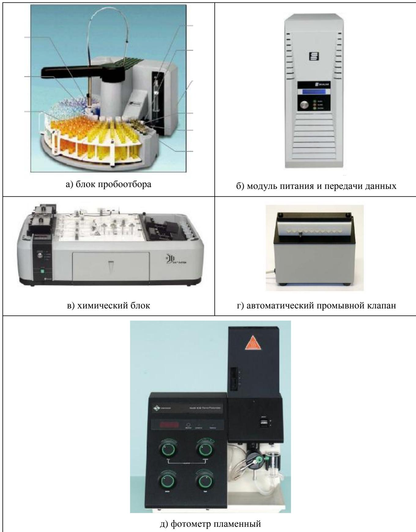
Рисунок 1 – Внешний вид блоков анализатора подвижных соединений фосфора и калия в почвенных образцах Skalar San++
