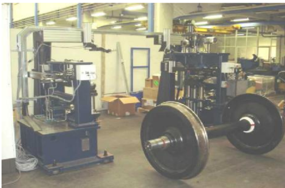
Рисунок 1 – Внешний вид машины для измерения колесных пар ОР220 модели D0100MW
