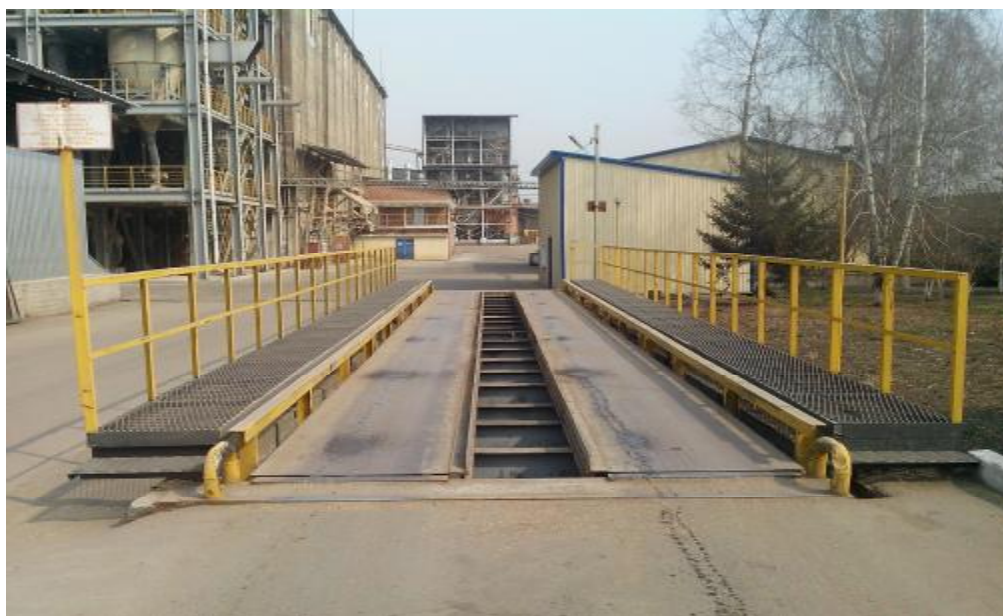
Рис. 1. Общий вид весов ВТСА
