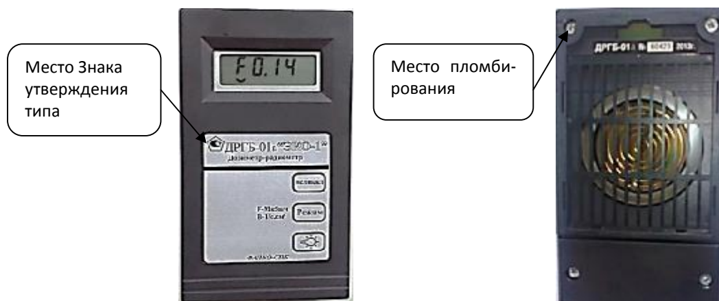
Рис. 1. Общий вид дозиметра-радиометра ДРГБ-01а «ЭКО-1»
