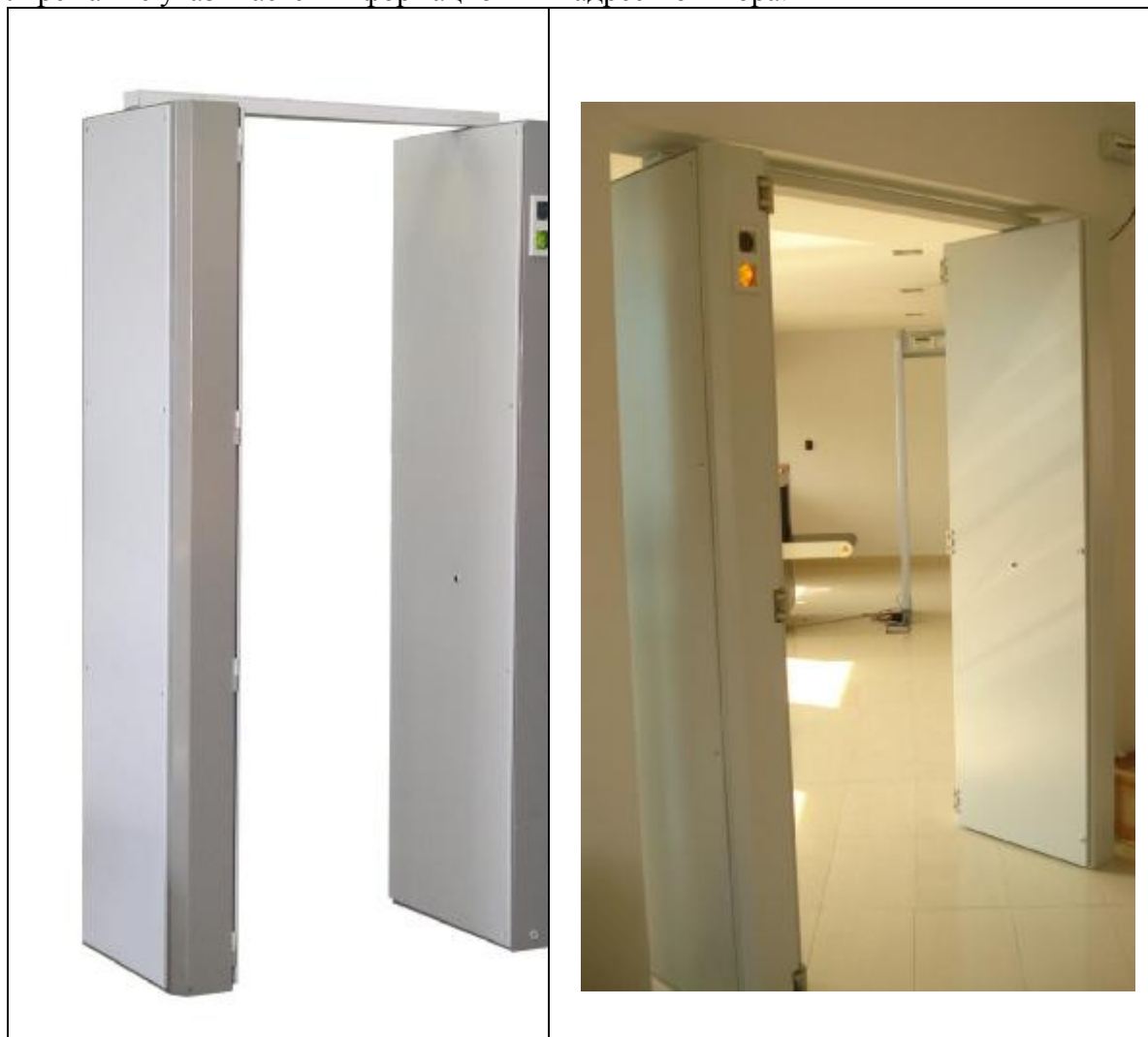
Рис. 1. Фотография общего вида монитора радиационного пешеходного КСАР1У.031 «ДОЗОР»
