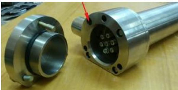
Рис. 12. Место пломбирования блоков БД-7-1, БД-7-1Д, БД-7-5, БД-7-5Д
