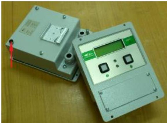
Рис. 13. Место пломбирования блока БОИ-4
