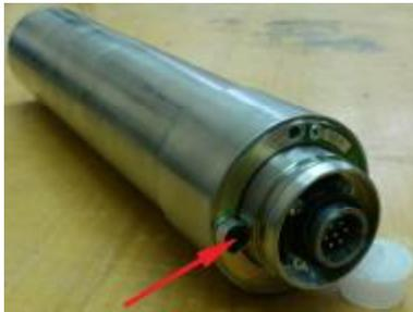
Рис. 11. Место пломбирования блоков БД-6-1, БД-6-1Д, БД-6-5, БД-6-5Д
