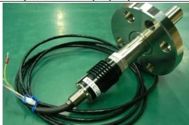
Рис. 1 Общий вид преобразователей давления измерительных РВ-80Н
