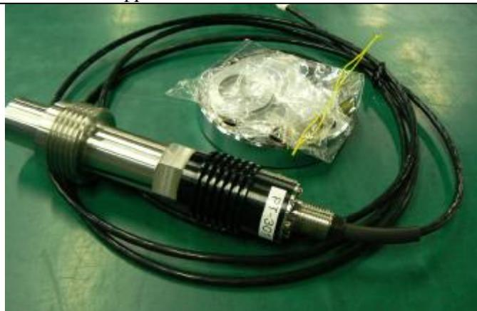
Рис. 2 Общий вид преобразователей давления измерительных РВ-5Н
