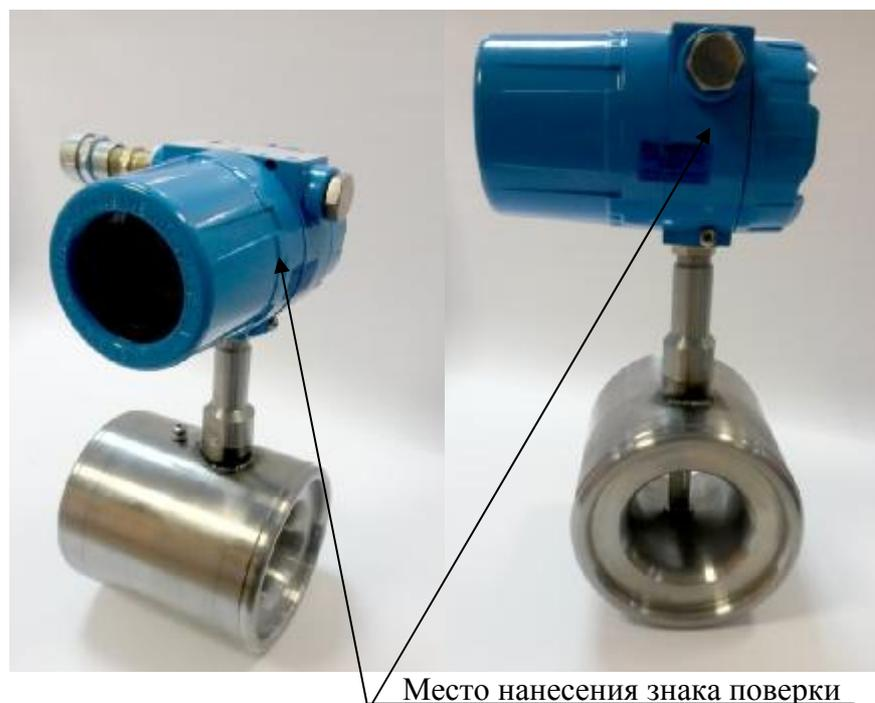
Рисунок 2 – Датчик расхода «DYMETIC-1204M-G»
