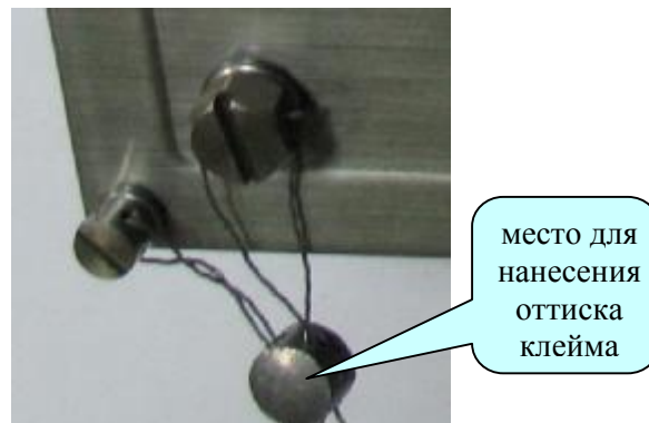
Рисунок 1. Схема защиты от несанкционированного доступа в настройки индикаторов CI-2001AS, CI-2001A и обозначение места для нанесения отиска клейма.
