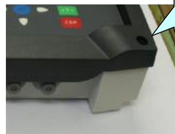
Рисунок 3. Схема защиты от несанкционированного доступа в настройки индикатора ВУ-2010С и обозначение места для нанесения оттиска клейма.
