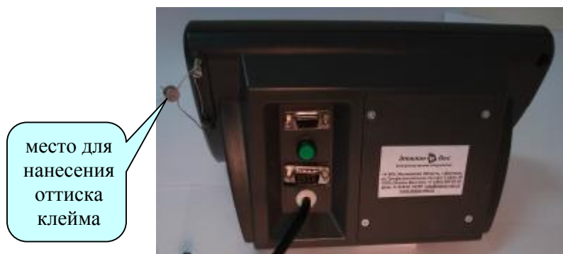
Рисунок 2. Схема защиты от несанкционированного доступа в настройки индикатора ВУ-2010 и обозначение места для нанесения отиска клейма.
