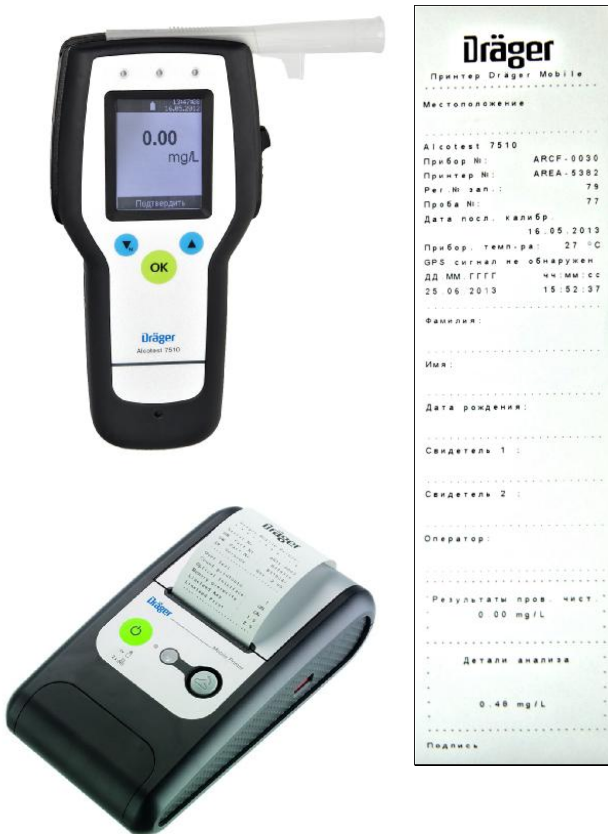
Рисунок 1 – Внешний вид анализаторов с принтером и пример распечатанного протокола измерения.
