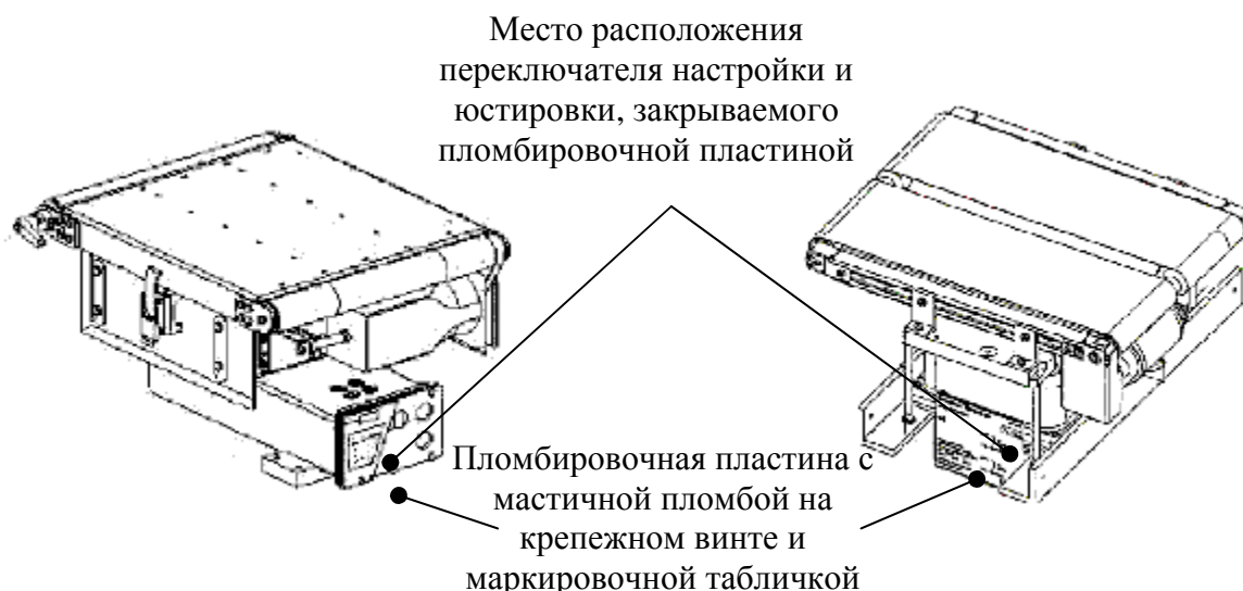
Рисунок 15 — Пример схем пломбировки ГПУ
