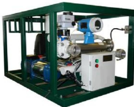
Рисунок 1 – Общий вид установок поверочных передвижных УПМВ
