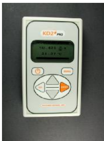
Рис.1 Прибор для определения теплофизических параметров материалов KD2 Pro
