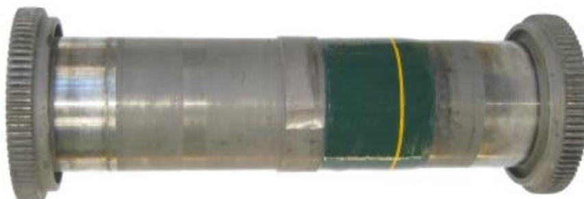
Рисунок 4 – Ротор измерителя со шлицами
