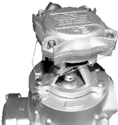
Рисунок 6 – Пломбировка датчика импульсов
