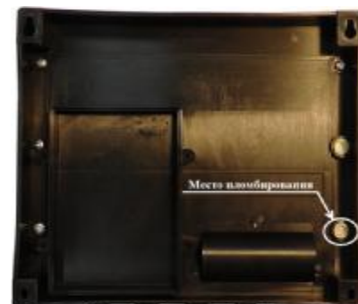
Рисунок 6 – Пломбирование тепловычислителя СПТ943
