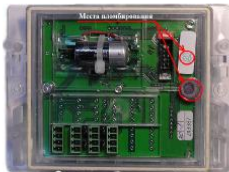
Рисунок 5 – Пломбирование тепловычислителя ВКТ-7
