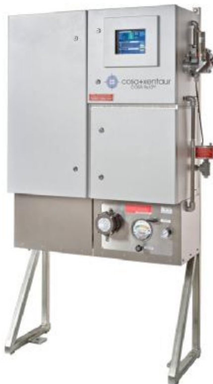
Рис. 1 Внешний вид измерителя числа Воббе 9610
