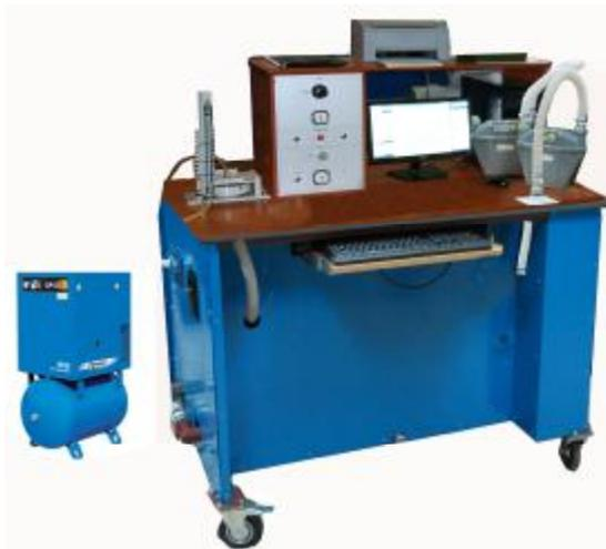
Установка работает следующим образом: воздух из помещения, где размещена установка, проходит последовательно через все поверяемые ГС (начиная с 6-го), коллекторы, включенные ручными вентилями или электромагнитными клапанами наборы МСК, ресивер, электромагнитные клапаны, вакуум-насос и выбрасывается из установки.
