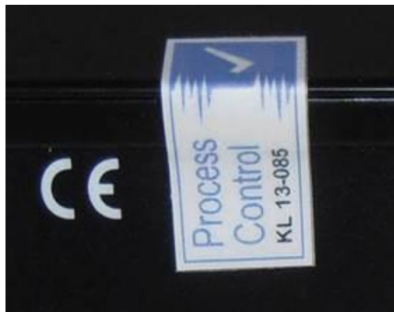
б – задняя панель – дополнительное пломбирование при помощи наклейки
