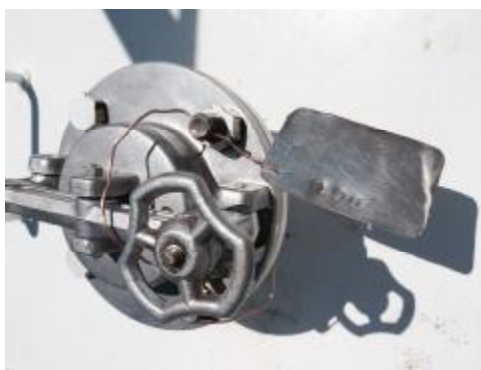
Рис.2 Схема пломбирования РГСД-25
