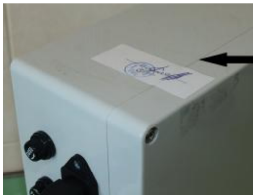
Рис. 2 Место пломбирования плотномера МД-02
