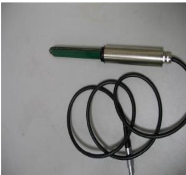
Рисунок 2 - Датчик ножевого типа НОЖ-1.
