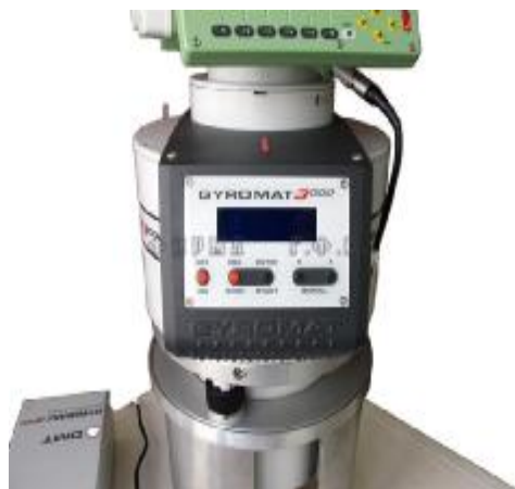
Рисунок 1 – Вид гиropлатформы со стороны фронтальной панели
