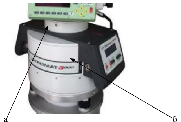
Рисунок 2 – Вид гиropлатформы со стороны задней панели а – место пломбировки б – место нанесения наклейки со знаком утверждения типа
