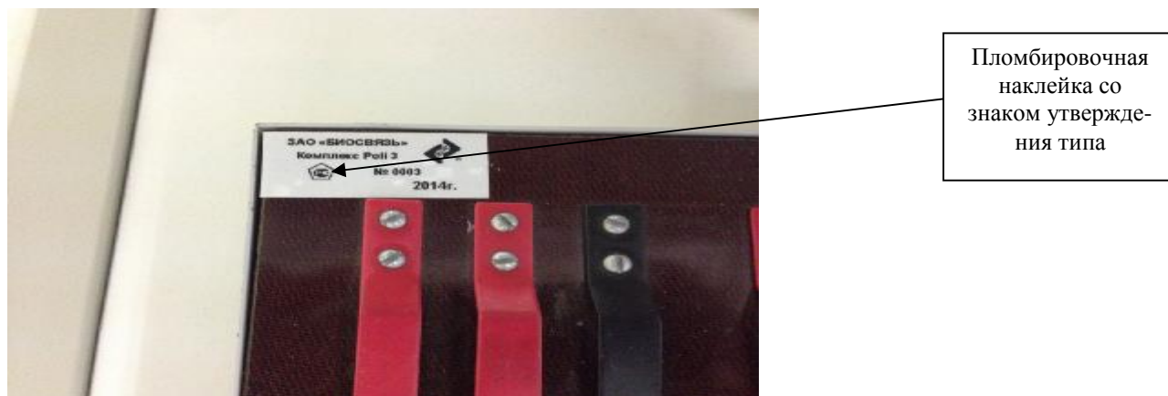
Рисунок 2. Место пломбирования и нанесения знака утверждения типа на верхней панели делителя напряжения «Poli 3»
