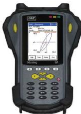
Рисунок 2 - Внешний вид приборов для измерения и анализа вибрации Microlog GX и Microlog Advisor Pro
